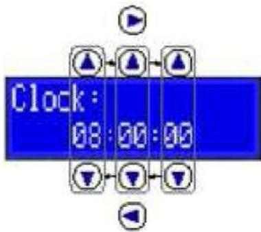
Empiece con el Reloj y la Fecha programe y confirme su opción con el botón central. Después de programar la hora (Izquierda, Derecha, Arriba y Abajo), pulse el botón central una vez más y guarde los ajustes. Volverá al estado de inicio. Repita la operación con la Fecha.
